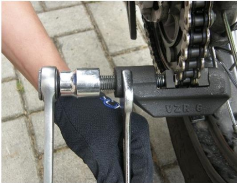
Bild 8: Für die ordnungsgemäße Installation von Rivet verwenden Verbindungsglieder Montagewerkzeug CZ VZR 6 und inklusive Messwerkzeug.
