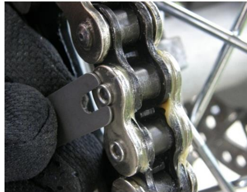
Bild 8: Für die ordnungsgemäße Installation von Rivet verwenden Verbindungsglieder Montagewerkzeug CZ VZR 6 und inklusive Messwerkzeug.
