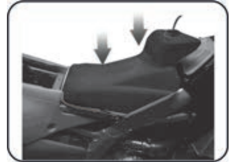
15. Place the Acerbis fuel tank on the bike. 15. Posizionare il serbatoio ACERBIS sulla moto.
