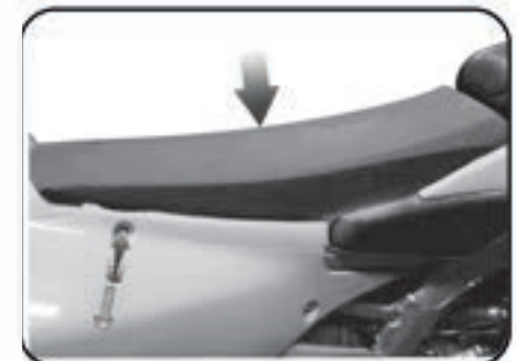
21. Reassemble the back of the seat using the original screws. 21. Rimontare la parte posteriore della sella utilizzando le viti originali.
