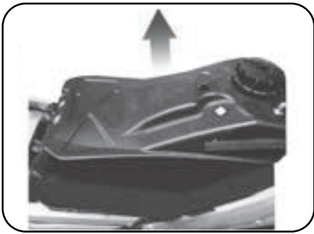
10. Remove the original fuel tank. 10. Rimuovere il serbatoio originale.
