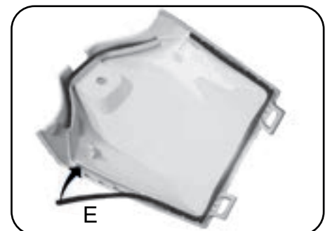
18. Fix the gasket E around the air filter cover Acerbis. 18. Montare la guarnizione E nel coperchio cassa filtro Acerbis
